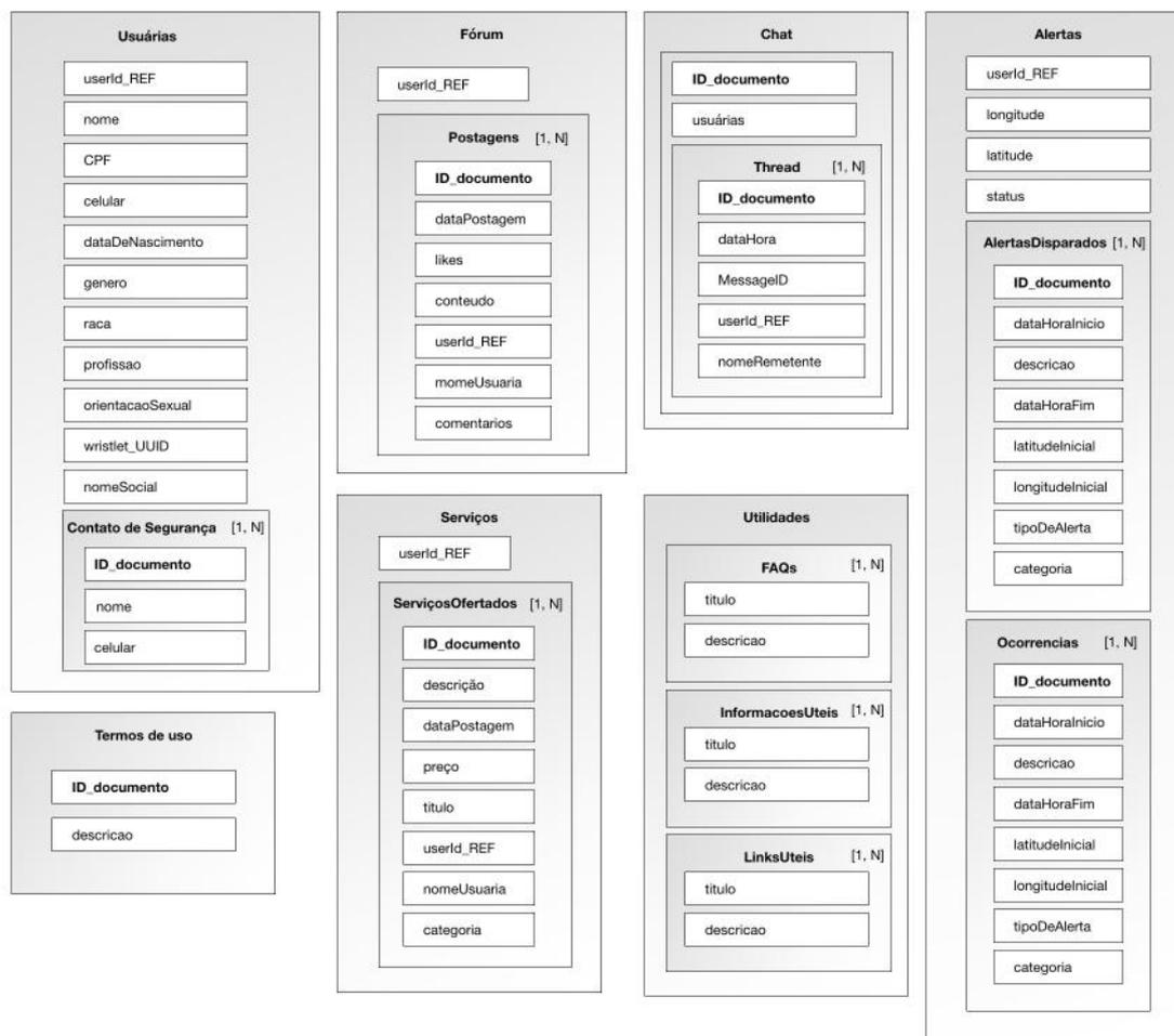
Figura 30 – Esquema lógico do Banco de Dados NoSQL
