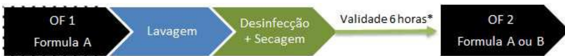
Figura 15: Procedimento normal de fabricação. Fonte: Adaptado pelo autor de procedimento interno da empresa, 2019
