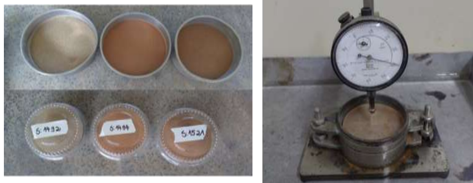
Figura 3.11 – Etapa de preparação do material para ensaio de expansibilidade e equipamento
