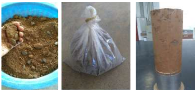
Figura 3.8 – Exemplo de passos da preparação dos corpos de prova dos materiais desta pesquisa
