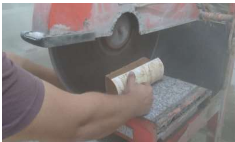
Figura 4.46 – Exemplo do processo de serragem dos corpos de prova de solo-brita
