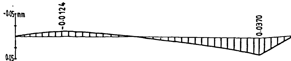
(d) Horizontal deflection of tower : Node 63
