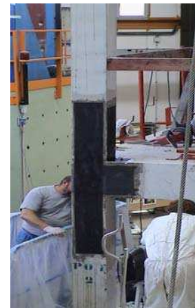
Σχήμα 5. Τοποθέτηση ΙΟΠ σε οριζόντια και κατακόρυφη μορφή
