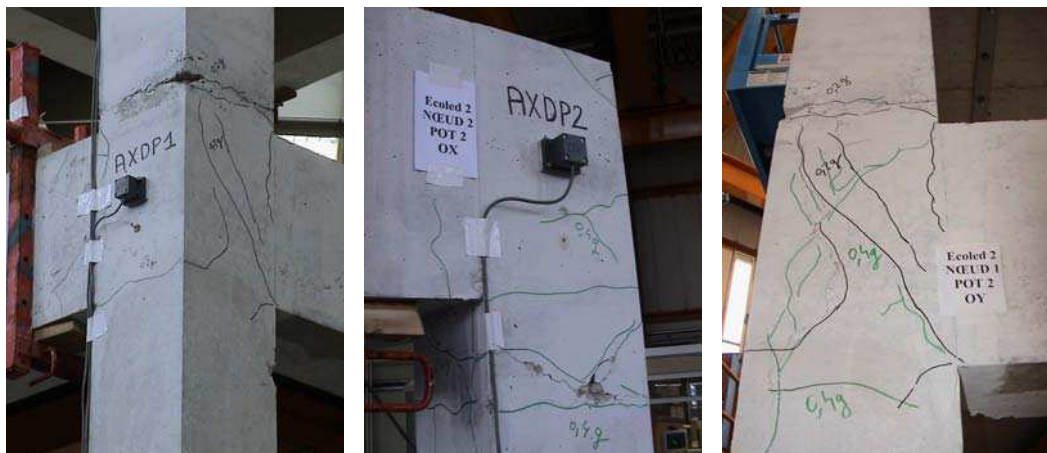
Σχήμα 2. Αριστερα: Μετά τη δόνηση των 0.2 g. Κέντρο και δεξιά: Μετά τα 0.4 g
