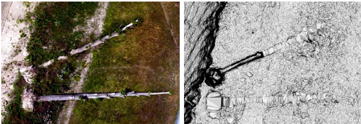
Abbildung 8-6: Visualisierung des Glättungseffektes an zwei Totholzstämmen bei Rhein-km 476,1 (links: Luftbild, rechts: hochaufgelöste Neigungskarte, berechnet aus dem DGM mit einem 15 x 15cm großen Berechnungsfenster)
