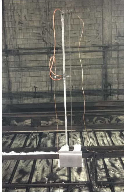
Abbildung 24 Höhenverstellbare Probenahmesonde auf dem Dach des Versuchsraumes
