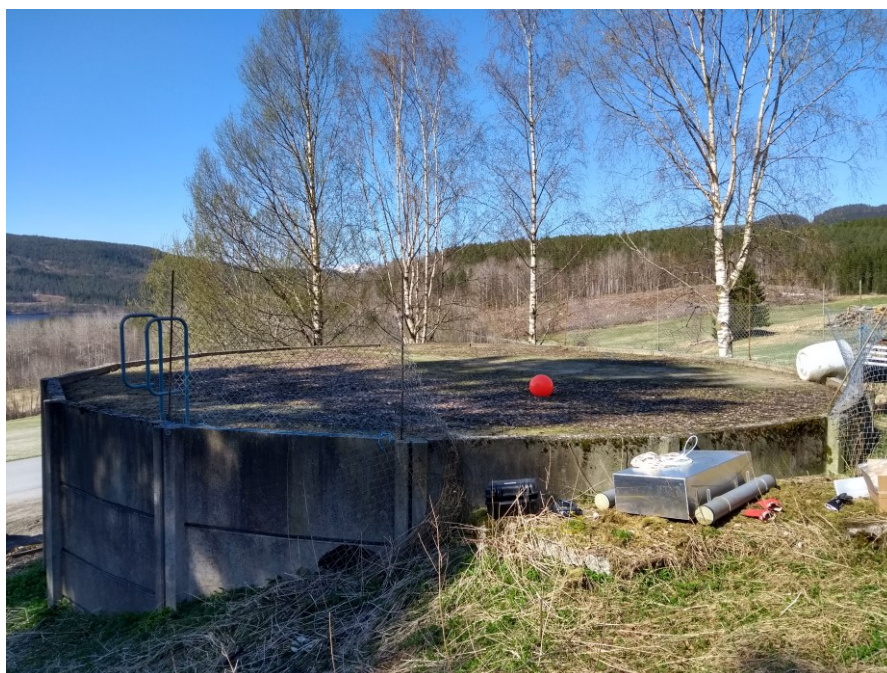
Bilde 8. Satellittlager med temperaturloggere som henger i kjetting fra garnblåsen midt i kummen. Utstyr for gassprøvetaging foran kummen. Foto Martha Ebbesvik, NORSØK
