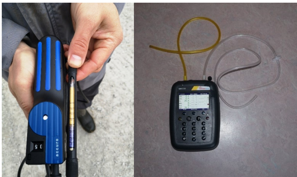
Bilde 7. Til venstre: Håndholdt måleutstyr som måler konsentrasjonen av ammoniakk som ble brukt i 2019. Kolonnen skifter farge til blå/fiolett når den utsettes for ammoniakk. Til høyre: Måleutstyr GA 5000 brukt i 2020. Foto: I. Kvande
