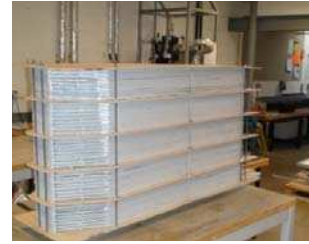
(d) Assembly of heat/mass exchanger
