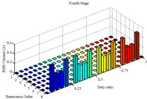
(d) Harmonics components in the stage-4 current
