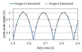
(d) Peak-to-peak ripple in stage-4 channel current
