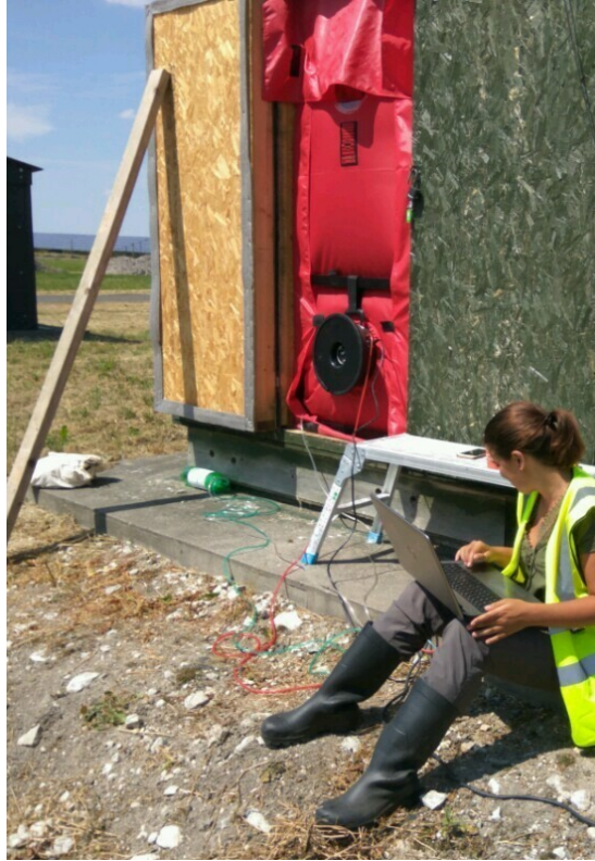
Fig. 4-10. Blower door test
