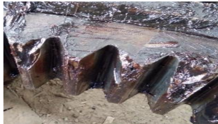
Gambar 10. Kerusakan Pada Swing Circle
