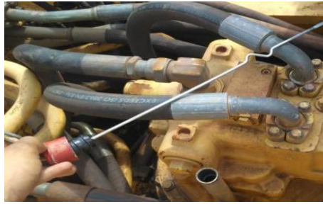
Gambar 3. Pemeriksaan Volume Oil Swing machinery
