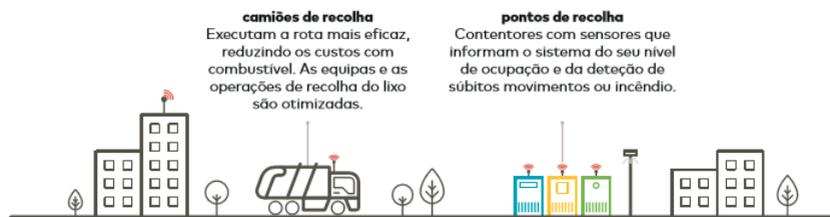
Figura 1. Arquitetura Exemplificativa do Sistema Smart Waste
