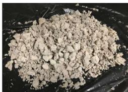
Figura 2. Enxofre elementar resultante do tratamento de biogás, Tratolixo.
