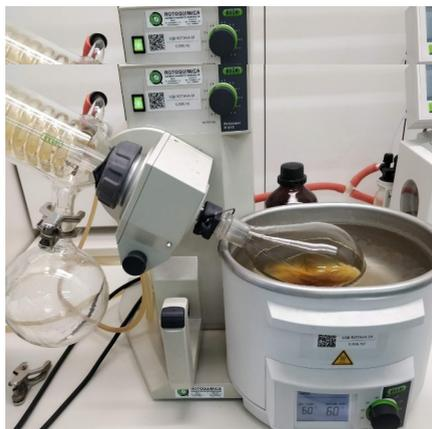
Figura 2. Recuperação do etanol em rotavapor.
