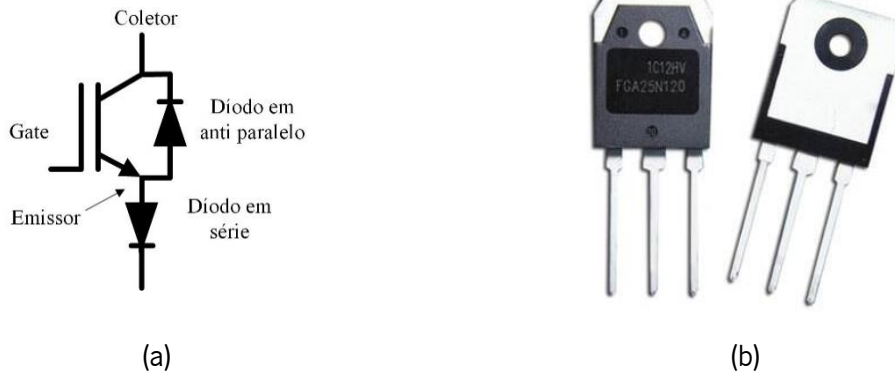
Figura 3.6 - Constituição de um IGBT com diodo antiparalelo adaptado para um Conversor Fonte Corrente: (a) Descrição do esquema elétrico; (b) Foto real do componente Fairchild FGA25N120ANTD [44].
