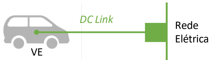
Figura 2.9 - Representação de carregamento Modo 4.
