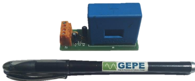
Figura 5.5 - Sensor de corrente LEM LA 100-P e sua respetiva placa de adaptação.
