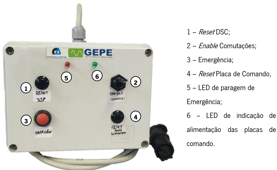
Figura 5.11 - Caixa de controlo utilizada no conversor de potência do carregador de baterias.
