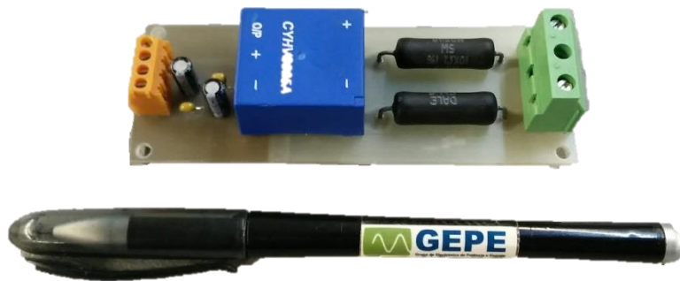
Figura 5.3 - Sensor de tensão CYHVS5-25A e a sua placa de adaptação.
