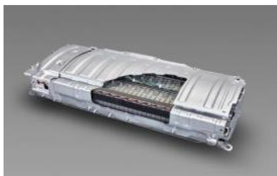
Figura 2.14 – Conjunto de baterias níquel-hidreto metálico utilizado nos VE da marca Toyota. [32]
