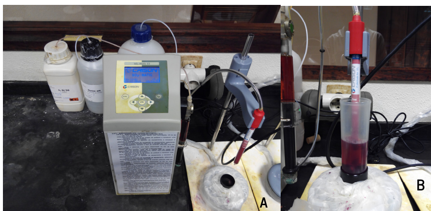
Figura 11 – Titulador automático CRISON Matic 23 (A) com eletrodo de SO 2 , dedicado à análise de vinhos (B).
