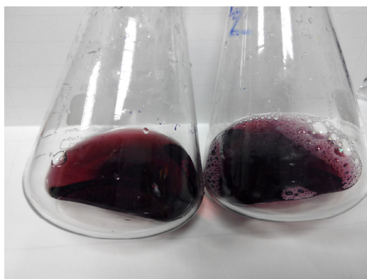
Figura 12 – Amostra de sangria antes (à esquerda) e depois (à direita) da titulação iodométrica.
