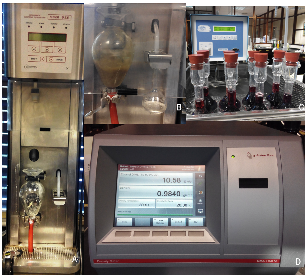
Figura 18 – Procedimento de determinação do título alcoométrico volúmico (A - Equipamento de destilação automático; B - Ebulição da sangria com leite de cal e silicone anti-espuma; C - Amostras de sangria no banho 20 °C; D - Densímetro digital).
