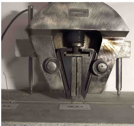
Figura 3: Ensayo de arrancamiento.
