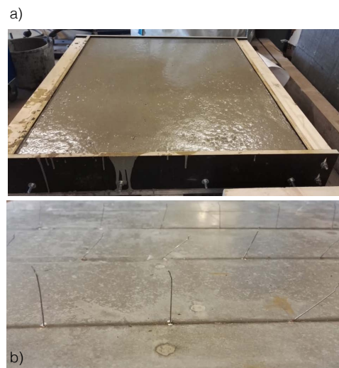
Figura 2: a) Molde con losa hormigonada; b) Fibras embebidas en la losa.
