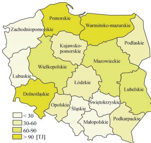
Rys. 41. Rozkład ilości energii możliwej do pozyskania rocznie z paneli fotowoltaicznych na zamkniętych składowiskach odpadów komunalnych w Polsce
