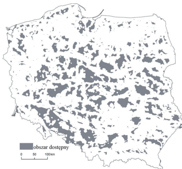
Rys. 15. Obszar dostępny pod budowę siłowni wiatrowych w Polsce, z uwzględnieniem form ochrony przyrody i leśnych kompleksów promocyjnych oraz strefy buforowej 2150 m
