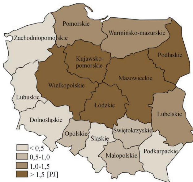
Rys. 7. Rozkład ilości energii możliwej do pozyskania rocznie z biogazu utylizacyjnego z gnojowicy zwierzęcej lub pomiotu ptasiego w Polsce
