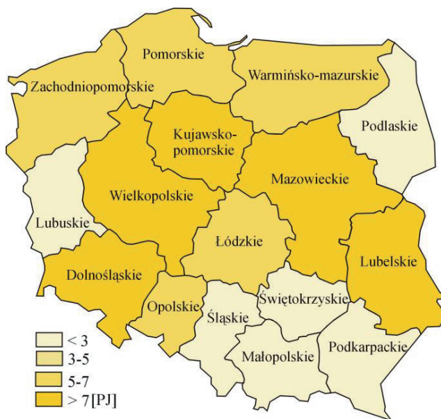
Rys. 4. Rozkład ilości energii możliwej do pozyskania rocznie z nadwyżek słomy w Polsce
