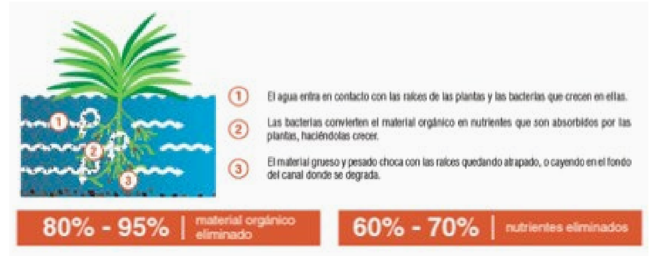
Figura 104. Tratamiento de aguas residuales con filtros verdes. Fuente: Global Nature Fund (2016).
