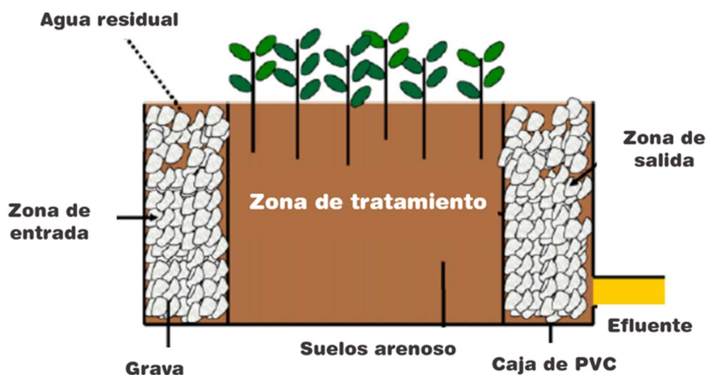
Figura 68. Diagrama esquemático de un manglar artificial para el tratamiento de las aguas residuales (Wu et al., 2008).
