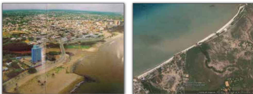
Figura 5. Panorámica de la desembocadura de Riíto en el año 2003, sin espolones y sin acreción en la zona del río posterior a su construcción
