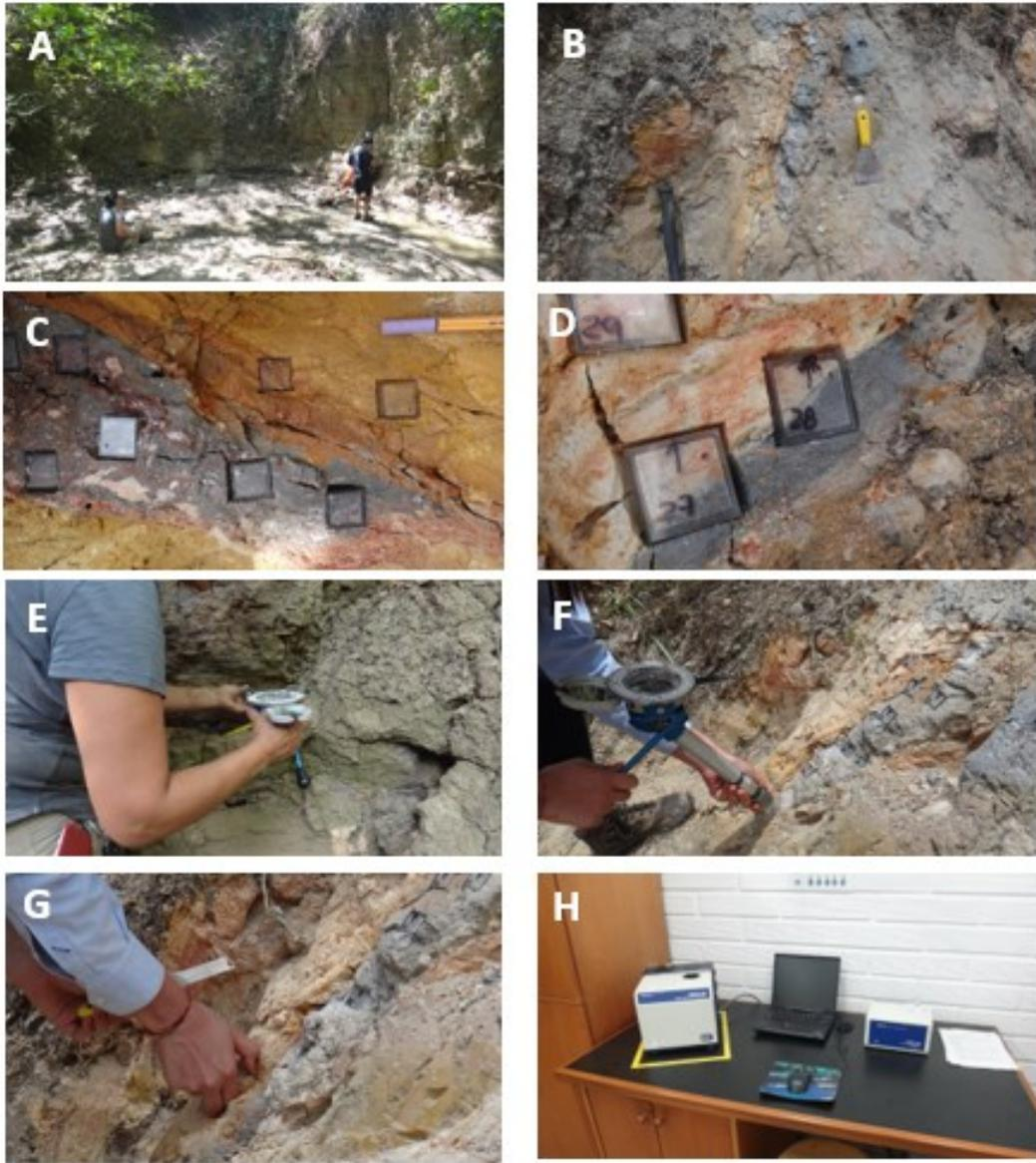
Figura 12. Fases del muestreo de campo para el área Oriental y Occidental. (A, B). Identificación y Limpieza del afloramiento. (C). Ubicación de las cajas de acrílico (D). Marcación de las cajas (E, F). Orientación de las muestras y toma de datos estructurales (G). Retiro de las muestras y (H). Medidas del laboratorio
