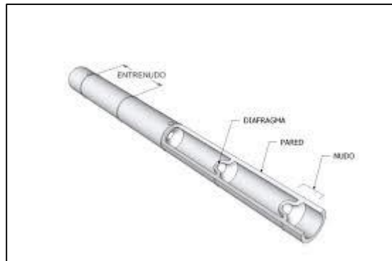
Fig. 9 Sección transversal de culmo de Guadua
