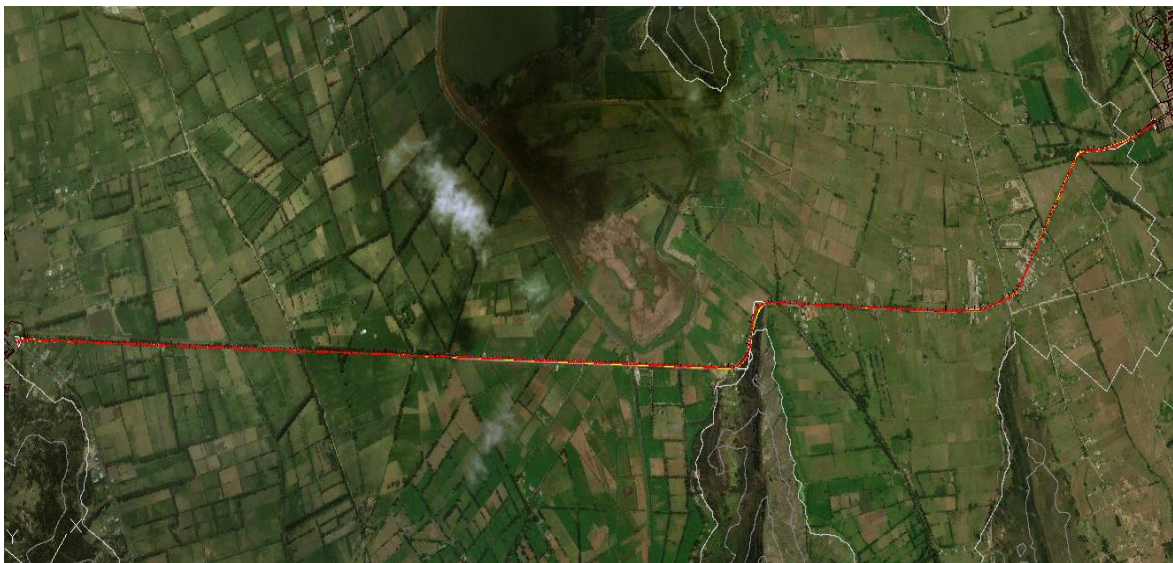
Ilustración 25. Diseño geométrico propuesto - Corredor vial Ubaté-Cucunubá.
