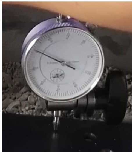
Ilustración 18. MONTAJE DE COMPARADORES DE CARÁTULA
