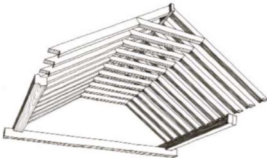
Figura 2.13: Armadura de par y nudillo. (Fuente: Enrique Nuere. Discurso de recepción en la Real Academia de Bellas Artes de San Fernando).
