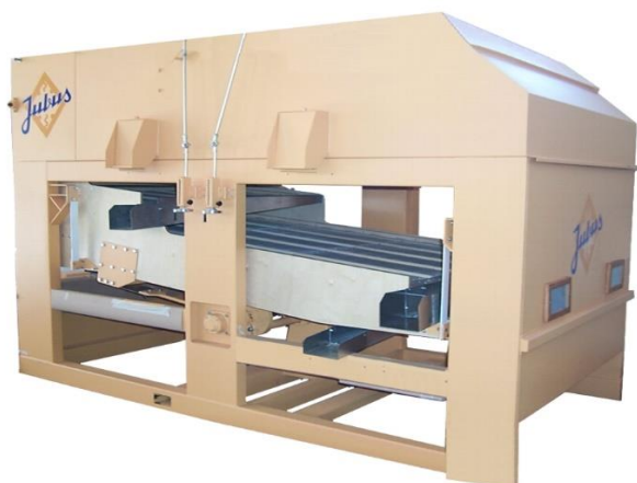
Figura 4. Separador limpiador de grano de cebada
