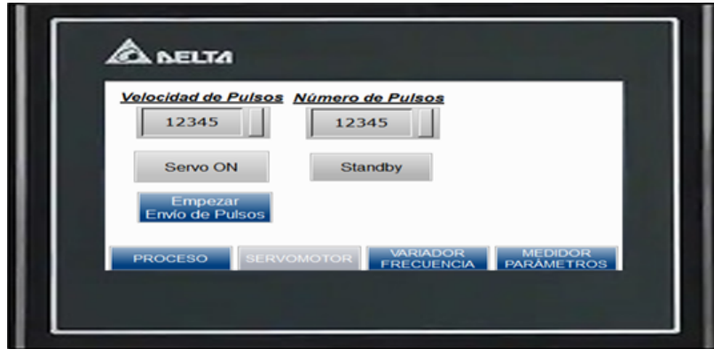
Figura 3.44: Pantalla para control de servo.
