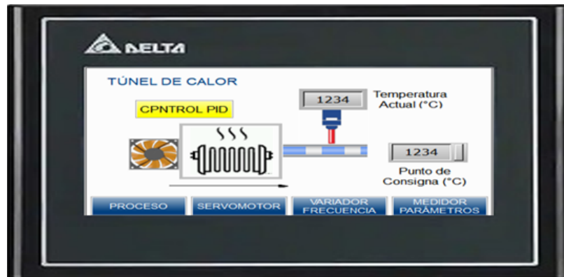
Figura 3.47: Pantalla para comandar el túnel de calor.
