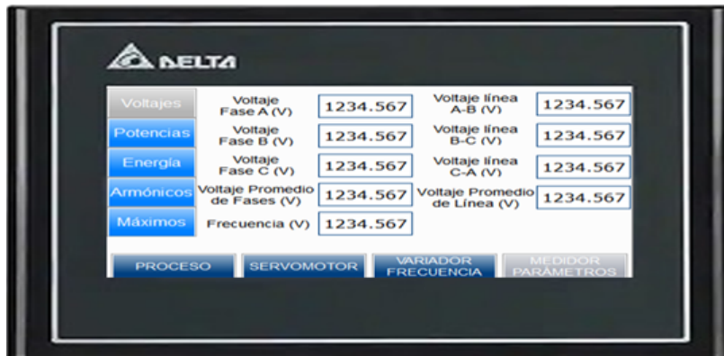
Figura 3.45: Pantalla del medidor de energía con el parámetro voltajes.
