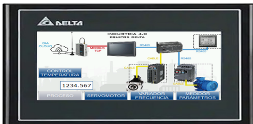
Figura 3.43: Pantalla de menú con esquema de conectividad física.
