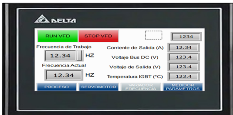
Figura 3.46: Pantalla para comandar el variador de frecuencia.
