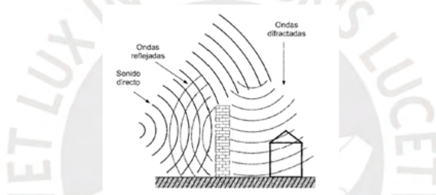
Figura 3: Reflexión de ondas sonoras en superficies.
