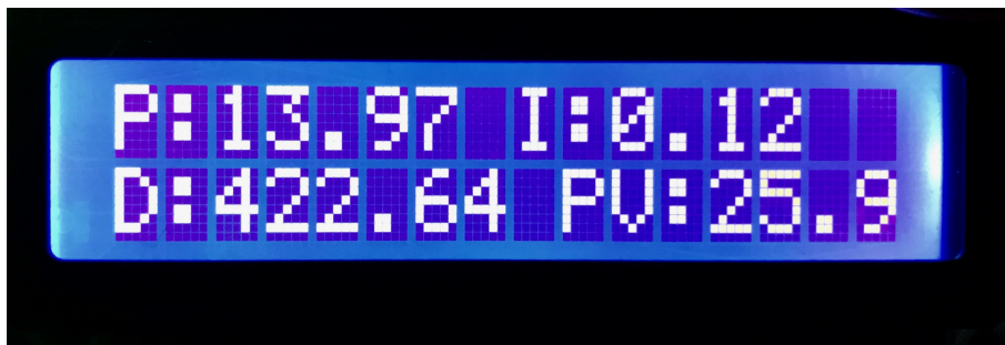
Figura 8.26 – Muestra de las constantes y la evolución de la variable del proceso por pantalla
