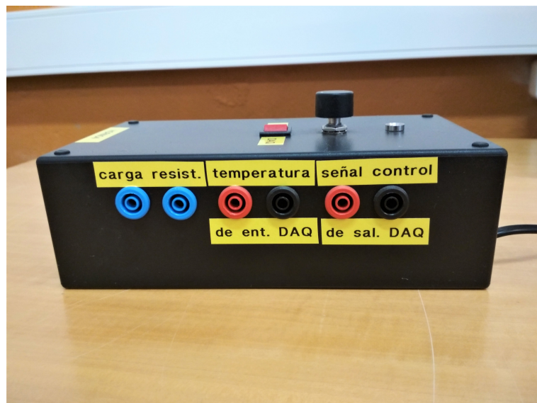
Figura 7.9 – Caja de acondicionamiento
