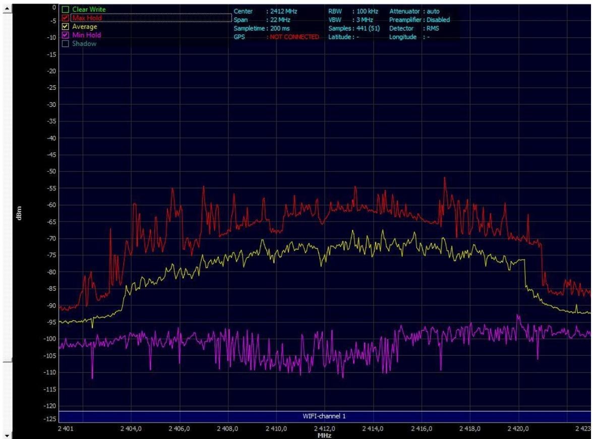
Figura B 7 Gráfico da análise espectral no canal 1 do Wifi (Rotação de 270°)
