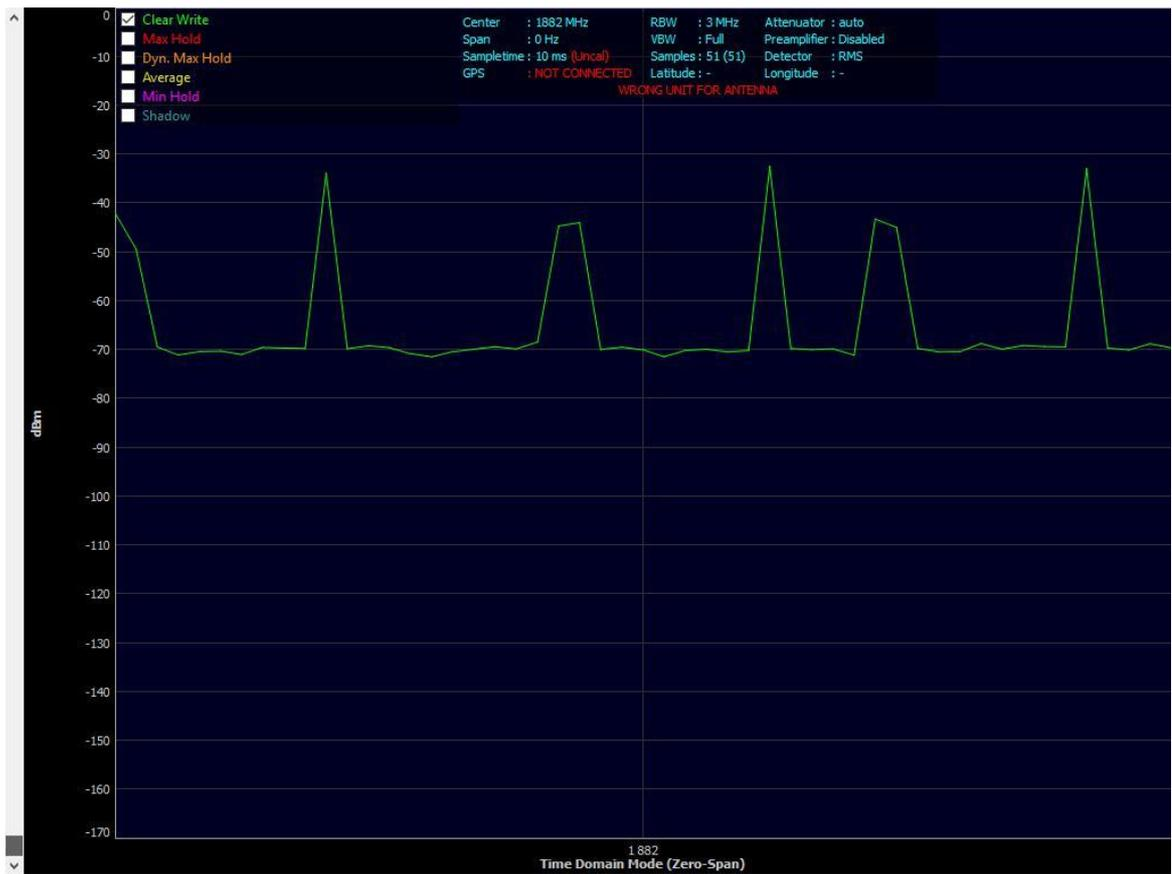
Figura B 17 Gráfico da análise espectral no domínio do tempo num canal DECT na frequência de 1882 MHz (d = 170 cm)
