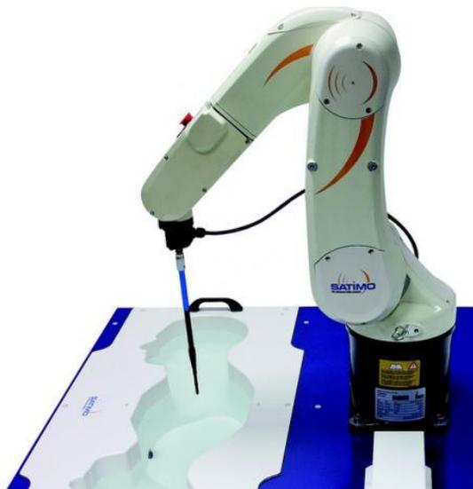
Figura 2.4 Sonda utilizada para medir SAR [9]
