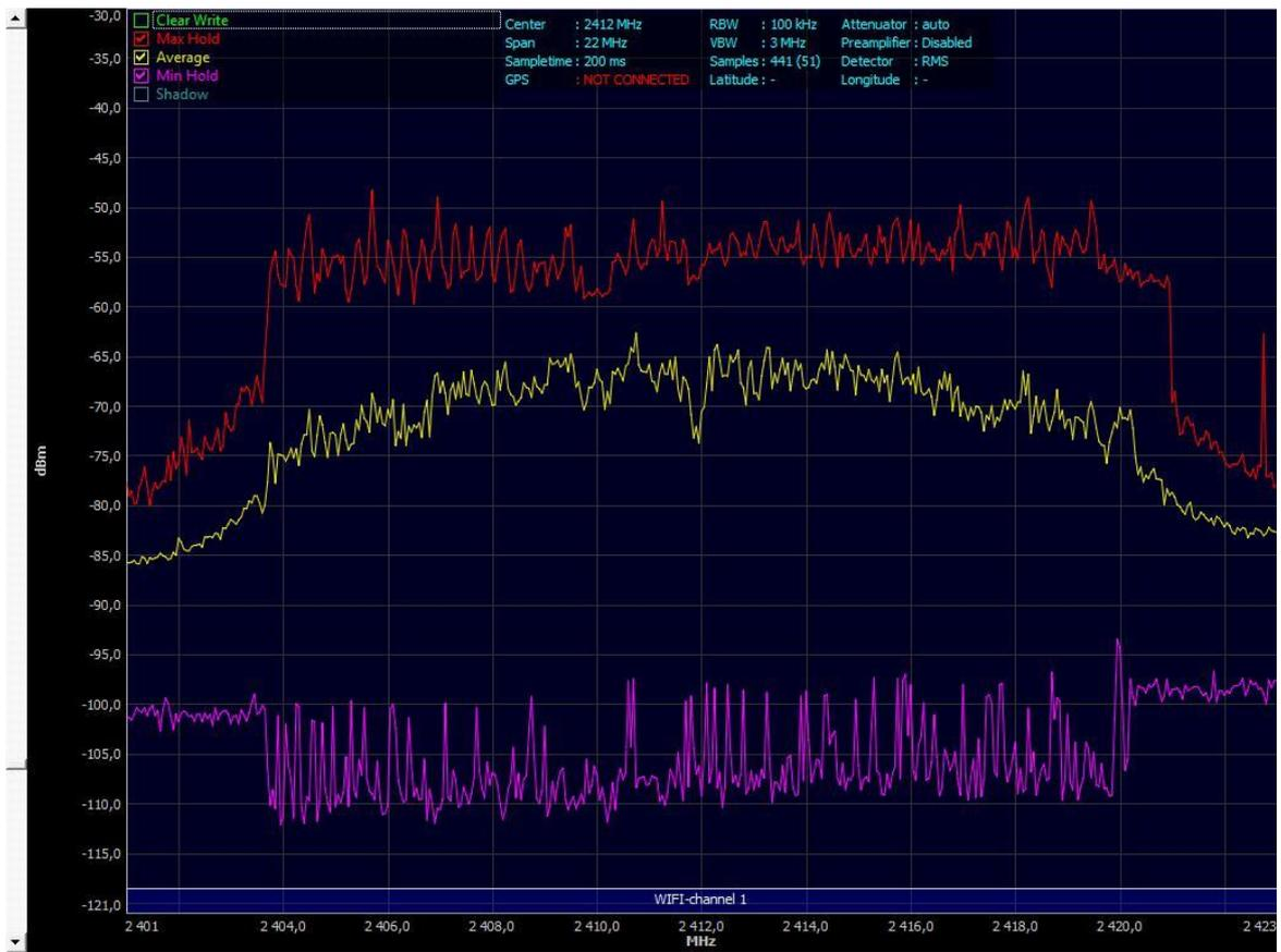
Figura B 3 Gráfico da análise espectral no canal 1 do Wifi (d = 220 cm)
