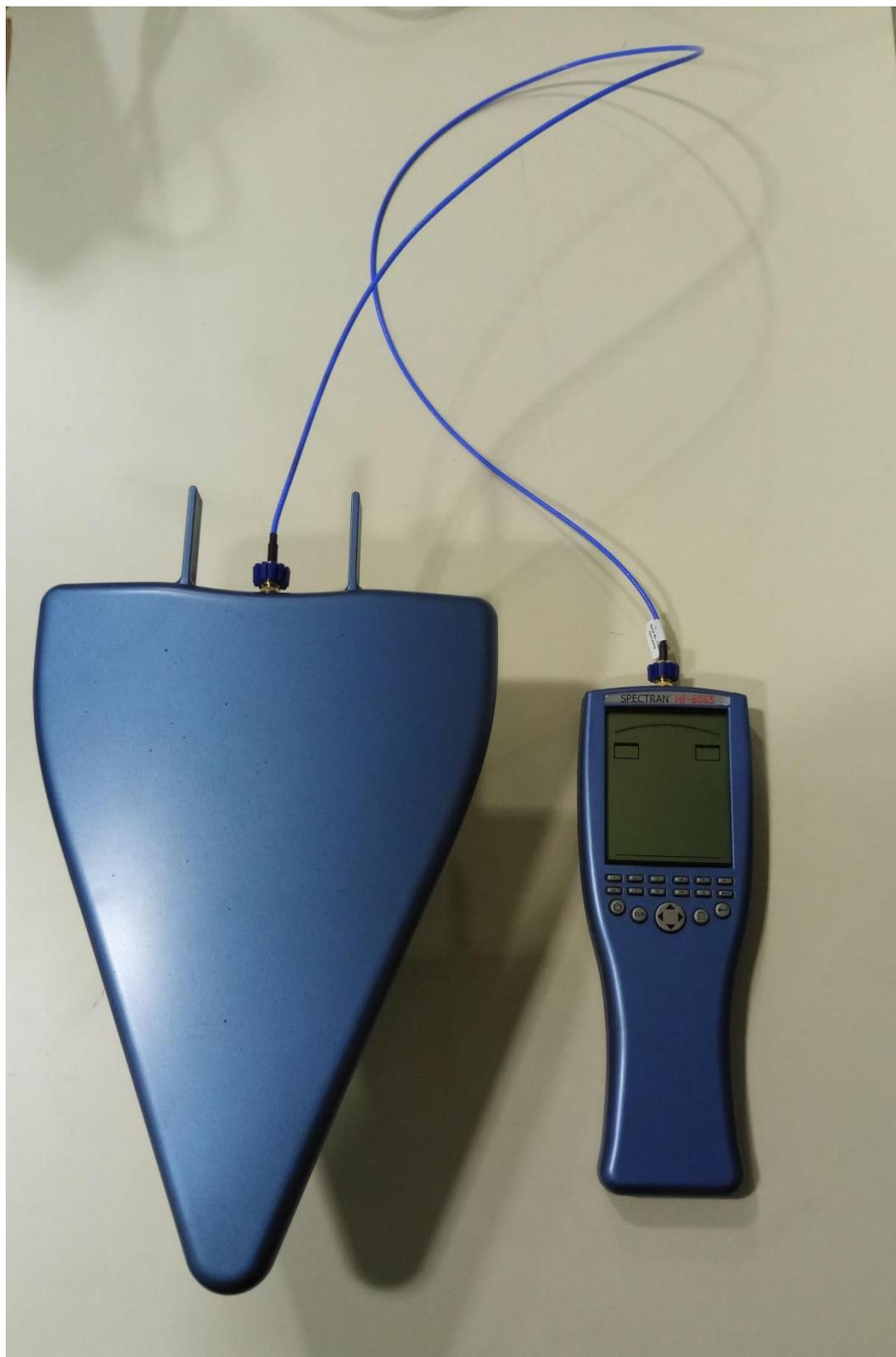
Figura A 4 Analisador espectral Spectran HF 6065
