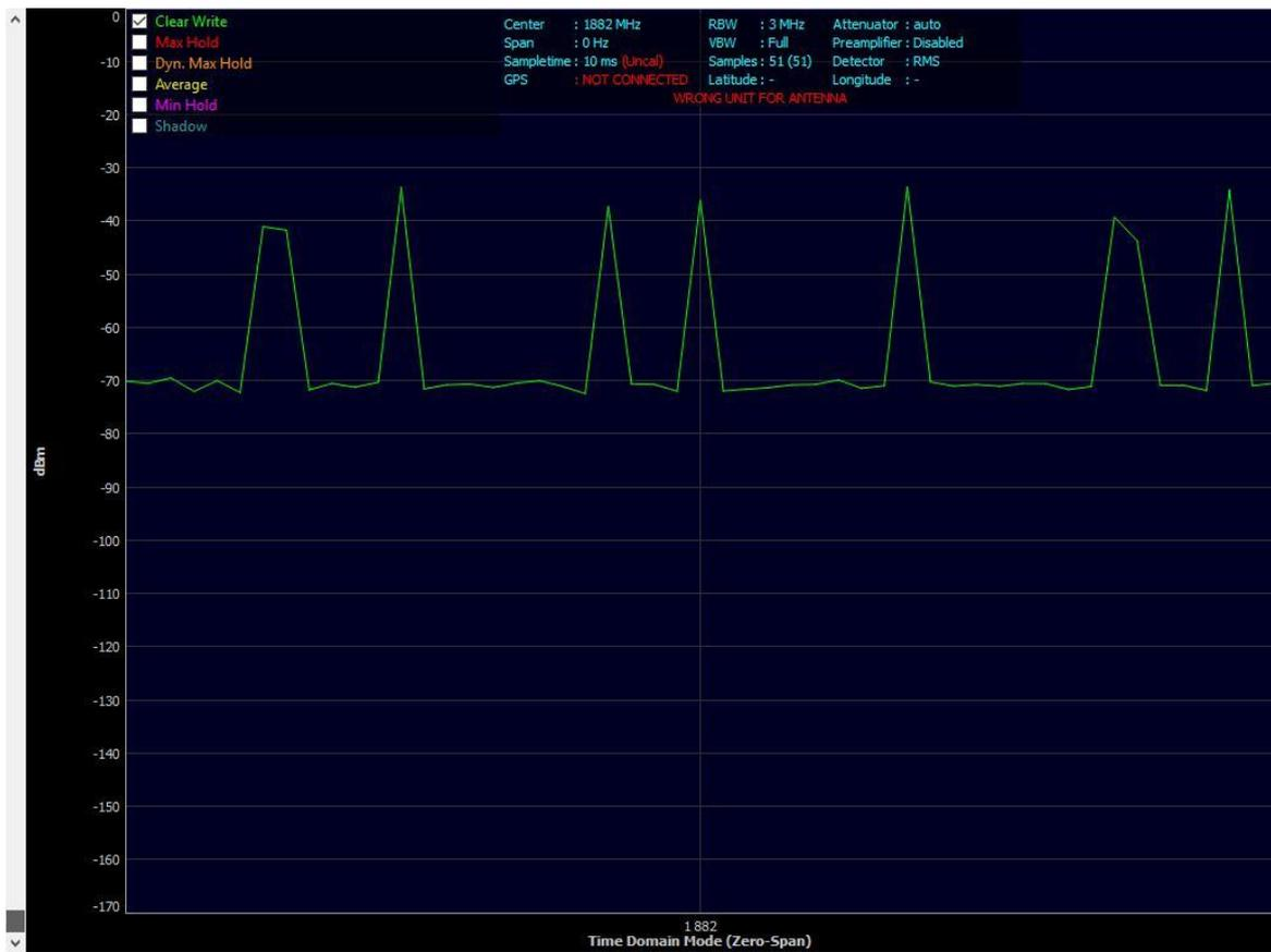
Figura B 16 Gráfico da análise espectral no domínio do tempo num canal DECT na frequência de 1882 MHz (d = 120 cm)
