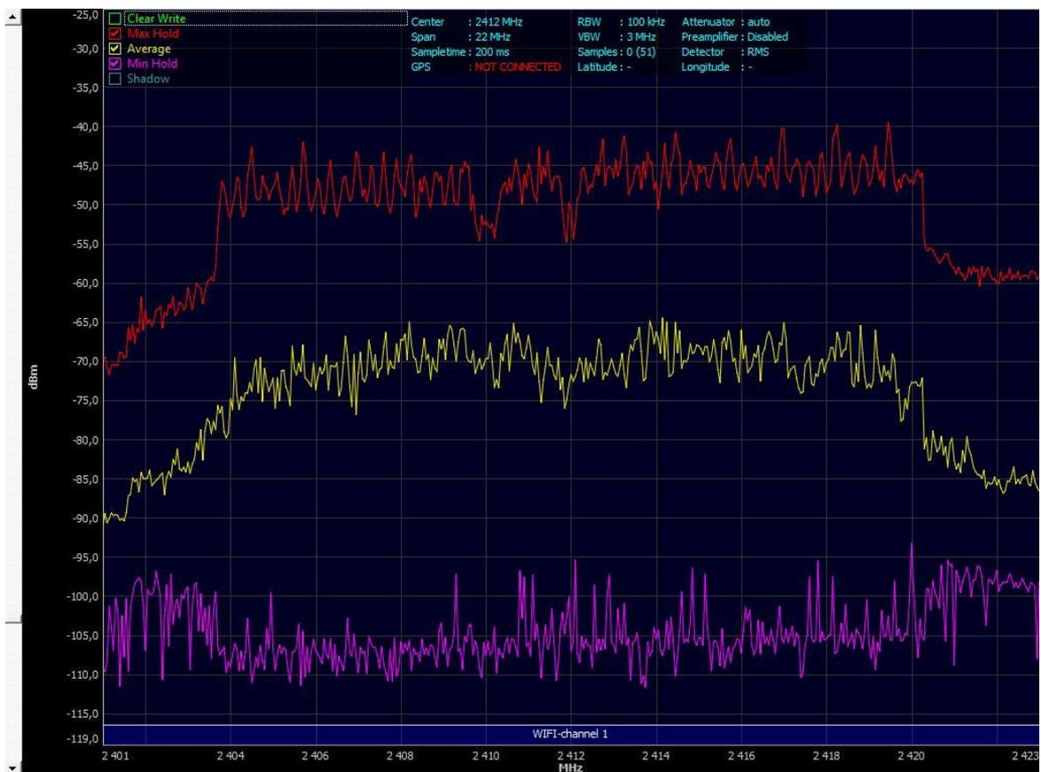
Figura B 1 Gráfico da análise espectral no canal 1 do Wifi (d = 120 cm)
