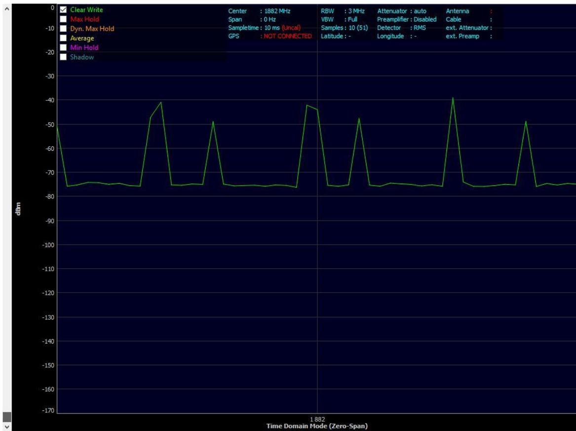
Figura B 18 Gráfico da análise espectral no domínio do tempo num canal DECT na frequência de 1882 MHz (d = 220 cm)
