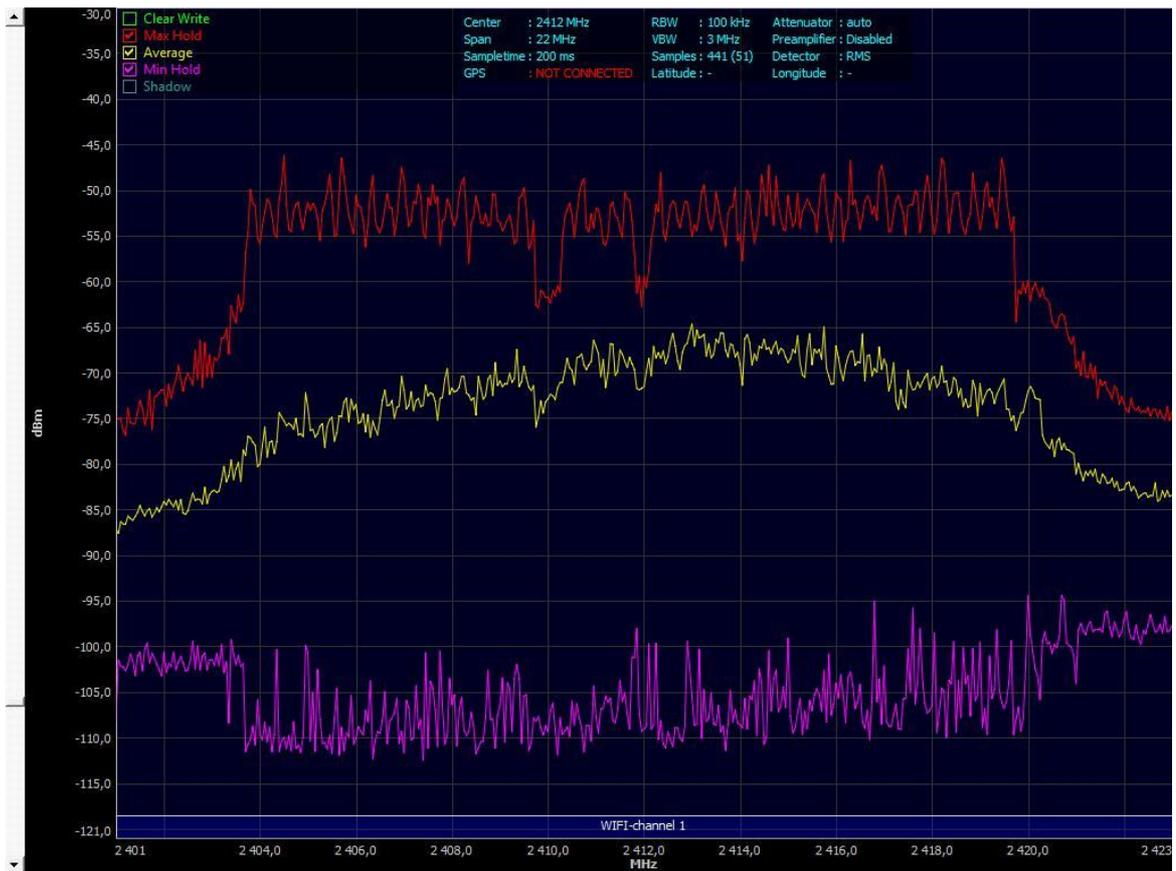
Figura B 2 Gráfico da análise espectral no canal 1 do Wifi (d = 170 cm)
