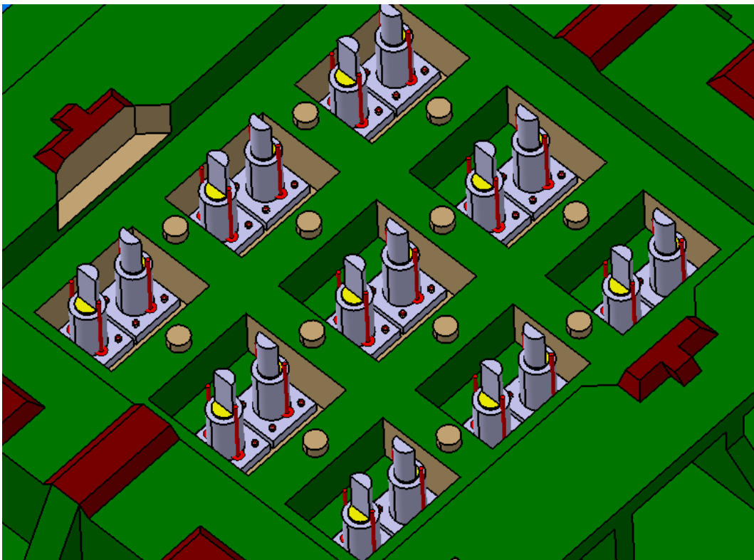
Figura 44 – Faces onde foram aplicadas as forças (Fonte – Construção própria)
