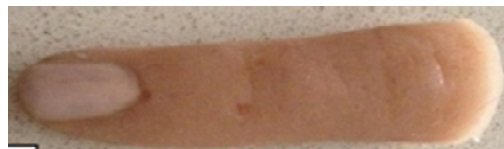
Figura 2.3 - Prótese de dedo em SLA
