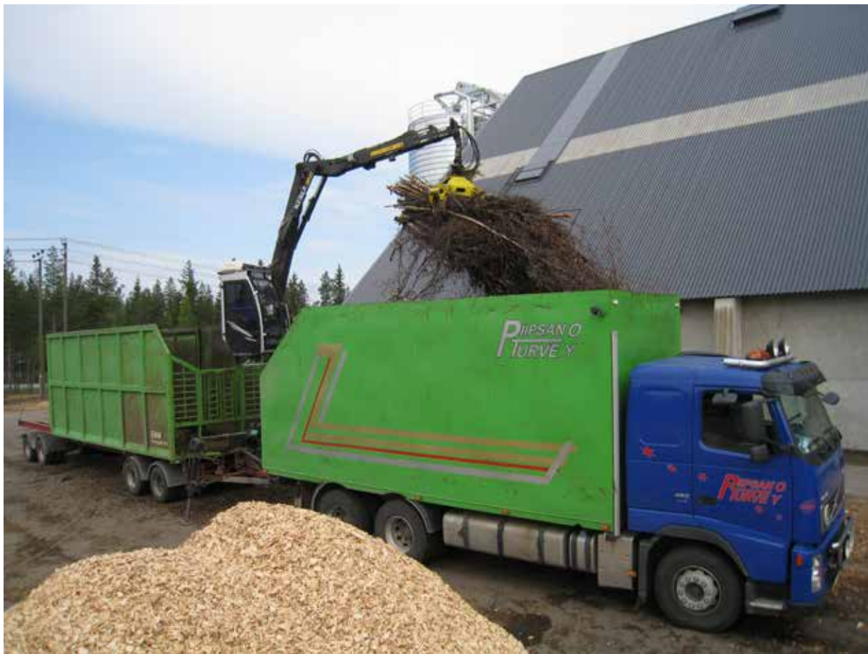
Pilt 18. Laasimata energiapuit või lahtised raiejätmed saab transportida terminali või lõppkasutajateni kinniste külgede ja kinnise põhjaga biomassi jaoks mõeldud veoautodega. (Foto autor: Juha Laitila)
