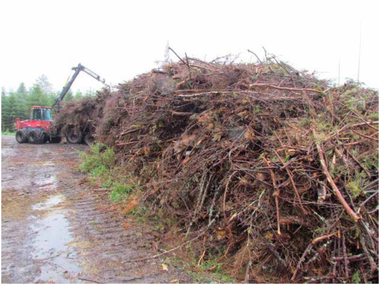
Pilt 20. Suurem osa hakkpuidust on toodetud teeäärsetel laoplatesidel. Pildil on kujutatud raiejäätmete mahalaadimine ja virnastamine. (Foto autor: Lars Eliasson)
