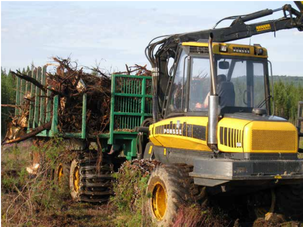
Pilt 40. Kändude teeäärsetele laoplatsidele transportimiseks on välja arendatud spetsiaalne kokkuveotraktori agregaat. (Foto autor: Juha Laitila)
