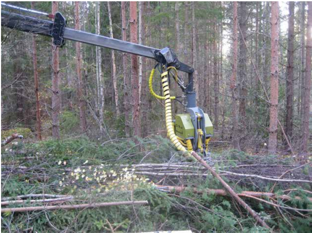
Pilt 8. Väikeste puude raiepeaga langetamiseks kasutatakse kolme järkamislahendust. (Foto autor: Maria Iwarsson Wide)
