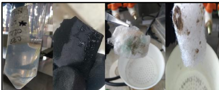
Figura 5. Resultados de las matrices usadas tras las pruebas de degradación con otros materiales hidrocarbonados
