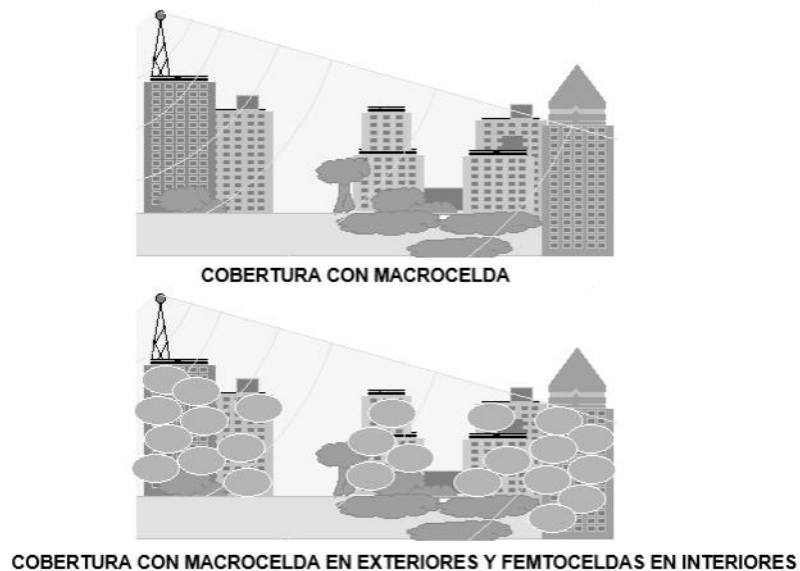
Figura 3. Cobertura en zona urbana con macrocelda y con dos niveles de macro y femtoceldas.
