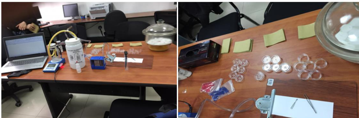
Figura 3. Equipo de calibración, bomba de muestreo, filtros, portafiltros y cassetes de muestreo
