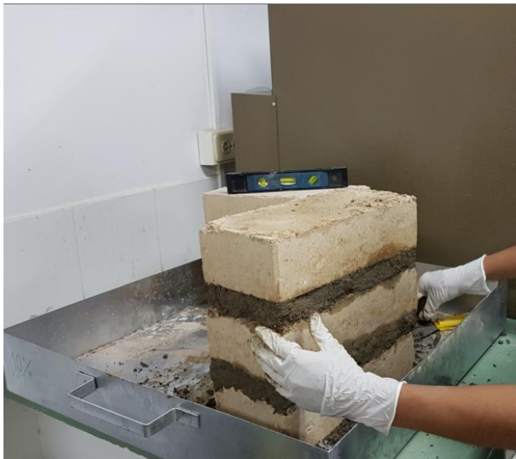
Figura 3. Murete fabricado con los BTC de mayor resistencia
