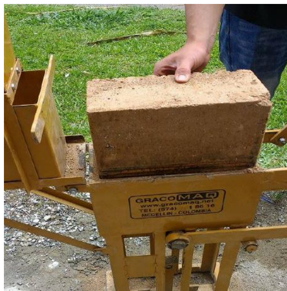
Figura 2. BTC fabricado con la mezcla suelo-cal-arcilla-escombros de concreto
