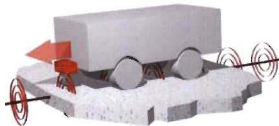
Figure 4- Guidage par ligne inductive [11]
