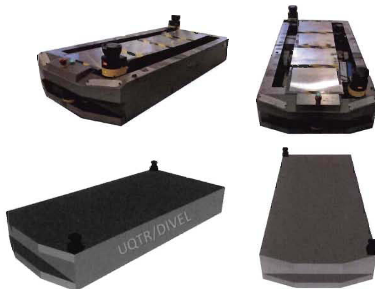
Figure 24-Plateforme mobile de DIVEL et son modèle 3D
