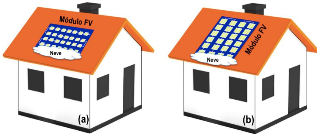
Figura 66 - Posicionamento de um módulo fotovoltaico de maneira horizontal (a) e vertical (b) com acumulação de neve [37].
