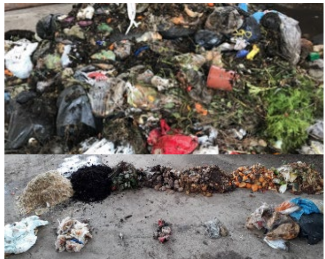
Figuur 5.9 Voorbeeld van sorteeraanlyse van ingezameld gfe. De foto links is voor het sorteren en de foto rechts is na het sorteren (Almere).
