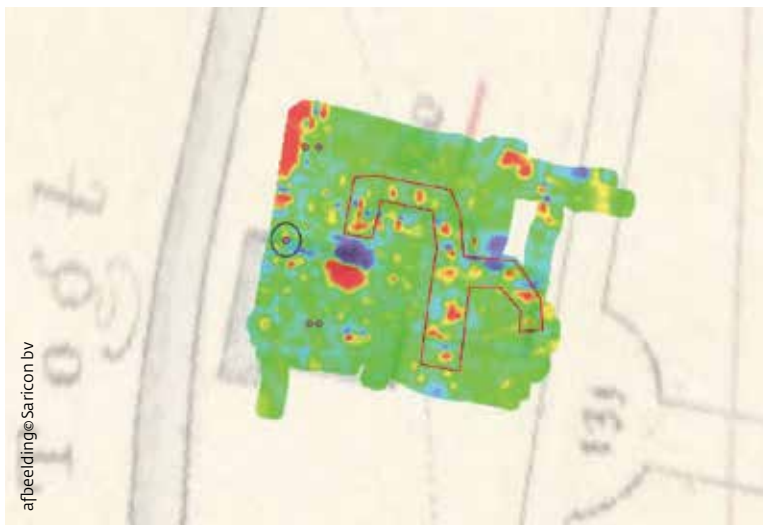
Magnetometriedata: binnen de rode lijn zijn de ritmische reflecties zichtbaar die te maken kunnen hebben met de voorganger van de schuilkerk. In de blauwe cirkel is de locatie van de poer te zien die in 2018 is gevonden.
