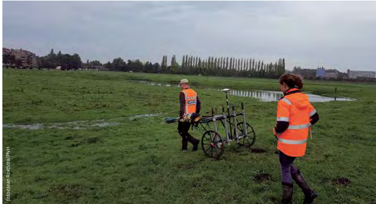
Boven: geofysisch veldwerker F. van den Oever, geofysicus, geassisteerd door de senior KNA-archeologe, mw. N. de Jong-Lambregts voeren een MAG-meting uit.
