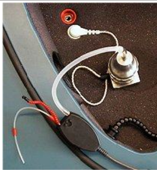
Fig. 4: Montaje de la medida en acoplador del RECD. Se observa de izquierda a derecha el auricular de inserción conectado al acoplador de 2 cm 3 , el adaptador al otro extremo y finalmente la sonda microfónica.
