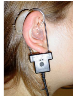
Fig. 3: Montaje de la medida en oído real del REAR. Se observa la sonda introducida en el CAE, el molde acústico y el audífono en funcionamiento.
