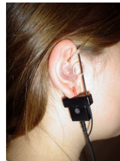
Fig. 5: Montaje de la medida en oído real del RECD. Se observa la sonda introducida en el CAE, el molde acústico personal y el auricular de inserción conectado al tubo del molde.
