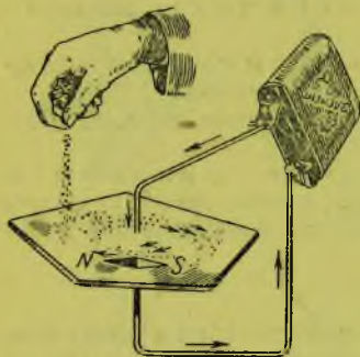
Рис. 106. Железные опилки располагаются вокруг провода концентрическими кругами
