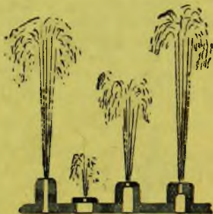
Рис. 102. Жиклеры одинаковых диаметров могут иметь разную производительность
