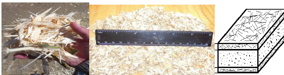
Рис. 1. Древесный заполнитель и конструкция слоистых блоков
