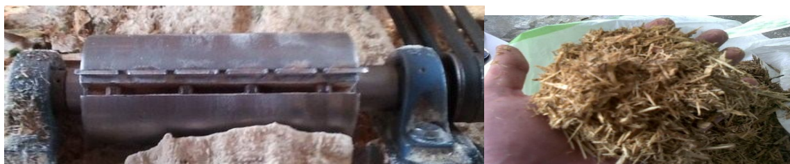
Рис. 2. Фреза с прерывистой режущей кромкой и образующаяся стружка
