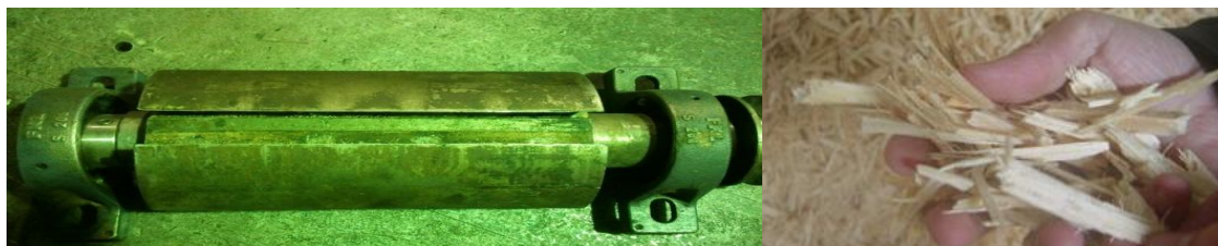
Рис. 1. Фреза со сплошной режущей кромкой и образующаяся стружка
