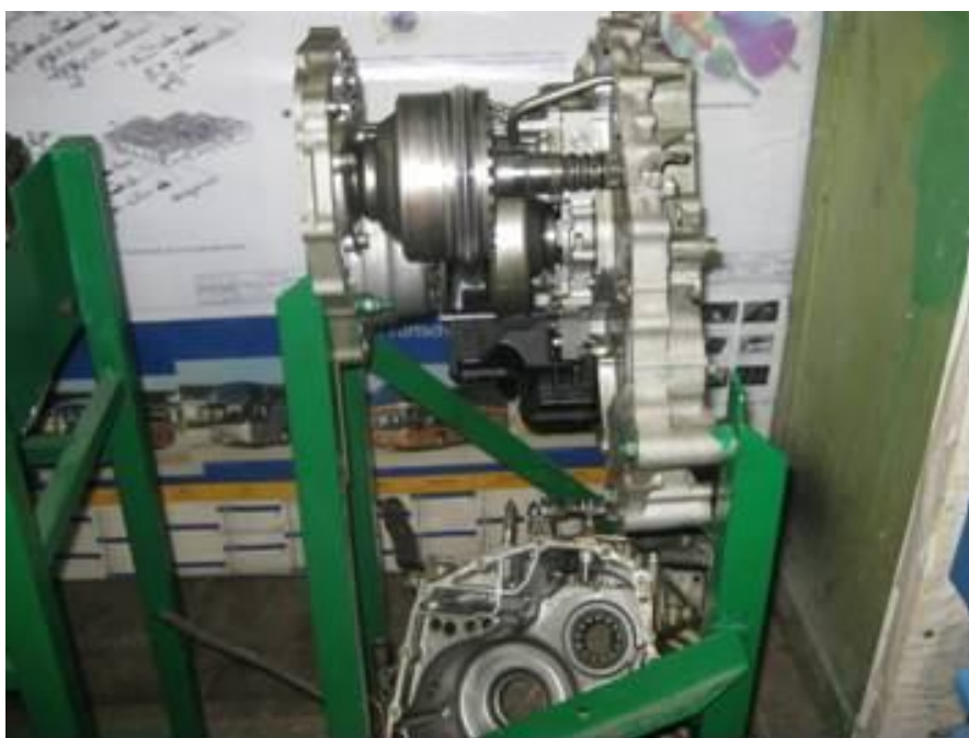
Рис 6, б. Стенд вариатора автомобиля «Honda Fit» в лаборатории кафедры сервиса и эксплуатации транспортных и технологических машин УГЛТУ
