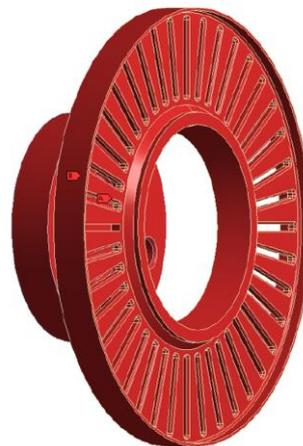
Abbildung 3-13: Bauteile, definiert als moving reference frame (MRF) [HES19a]
