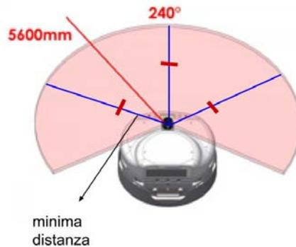
Figura 3.5: Gli angoli fissati all'interno del campo visivo di 240° sono delimitati dalle semirette blu. Si verifica che la distanza 1 e 3 sono minori della metà della minima distanza e la distanza 2 è minore della minima distanza. Per rappresentare le distanze ho usato dei trattini rossi.
