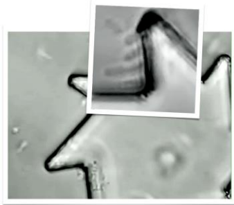
Fig 6: Ingranaggio micrometrico; nella seconda immagine si vede chiaramente come il moto dei batteri può far girare il dispositivo. (8)
