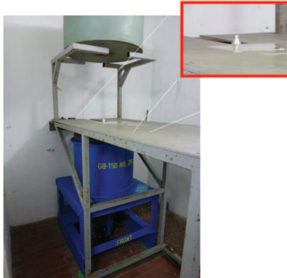
Figura 4.1: Facility utilizzata per l'irraggiamento con raggi \gamma . Durante l'irraggiamento il cilindro contenente la sorgente di ^{60}Co viene estratto dal contenitore di piombo che lo circonda.
