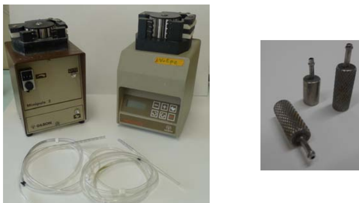
Figura 5.2: Le pompe ed i supporti utilizzati per la perfusione. La cannula utilizzata può essere costituita di diversi materiali (metallo, vetro o plastica). Per quanto riguarda il diametro esso è simile o leggermente maggiore del calibro dell'aorta, in quanto deve permettere l'inserimento nell'aorta e presentare un diametro sufficiente da non costituire un impedimento al flusso. Per la perfusione, il cuore viene collegato ad una pompa peristaltica a cui viene imposto un funzionamento a flusso costante.
