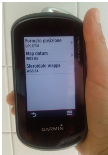
Figura 20: impostazioni sistema di riferimento per il GPS
