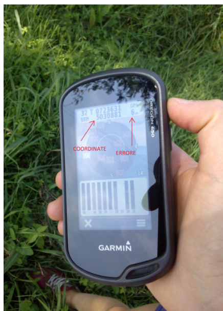
Figura 21: Schermata del Gps in cui comparivano posizione e incertezza della misura
