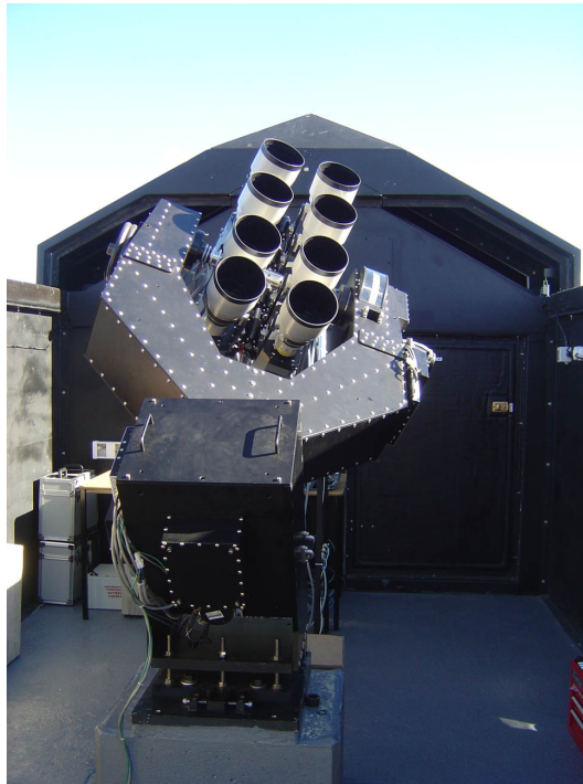
Figura 1.4: Immagine delle 8 camere a grande campo di SuperWasp (immagine tratta da [94]).
