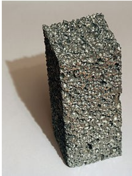
Fig.1.6. Schiuma di alluminio a celle chiuse
