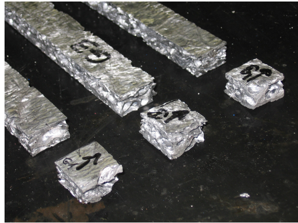
Fig.2.2. Taglio provini della schiuma G per misura densità (a) e per analisi di immagine (b)
