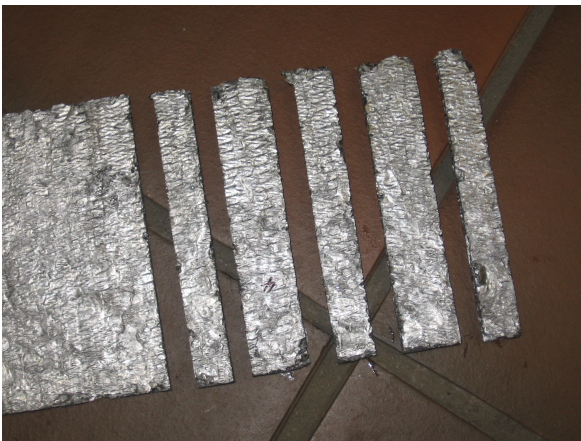
Fig.2.2. Taglio provini della schiuma G per misura densità (a) e per analisi di immagine (b)
